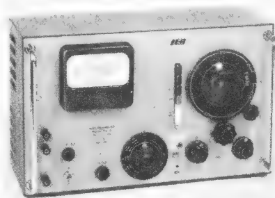
Klirrfaktormesser und Millivoltmeter der Firma LEA, Rueil (S.-8.-O.)
