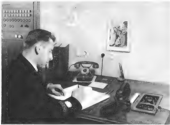
Bild 3. Der Arbeitsplatz des Kommandanten enthält rechts das Bedienpult des auch bisher verwendeten Funksprechgerätes. Links im Hintergrund der neue Steuer-schrank mit den Selektivruf-Generatoren
